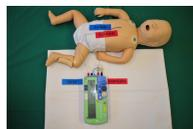
Abb. 1: Technischer Aufbau beim AVT-Pacing am Modell. Die Schrittmacherkable werden an den Eingängen vertauscht.
