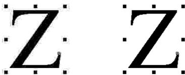
Das linke Bild ist eine JPEG-Datei mit 1138 Byte, das rechte eine PNG-Datei mit 571 Byte. Das »JPEG«-Format ist gut geeignet für Fotografien; enthält das Bild allerdings große Farbflächen und scharfe Übergänge, dann ist eine verlustfreie Kompression wie sie im PNG-Format benutzt wird, die geeignetere Methode.
