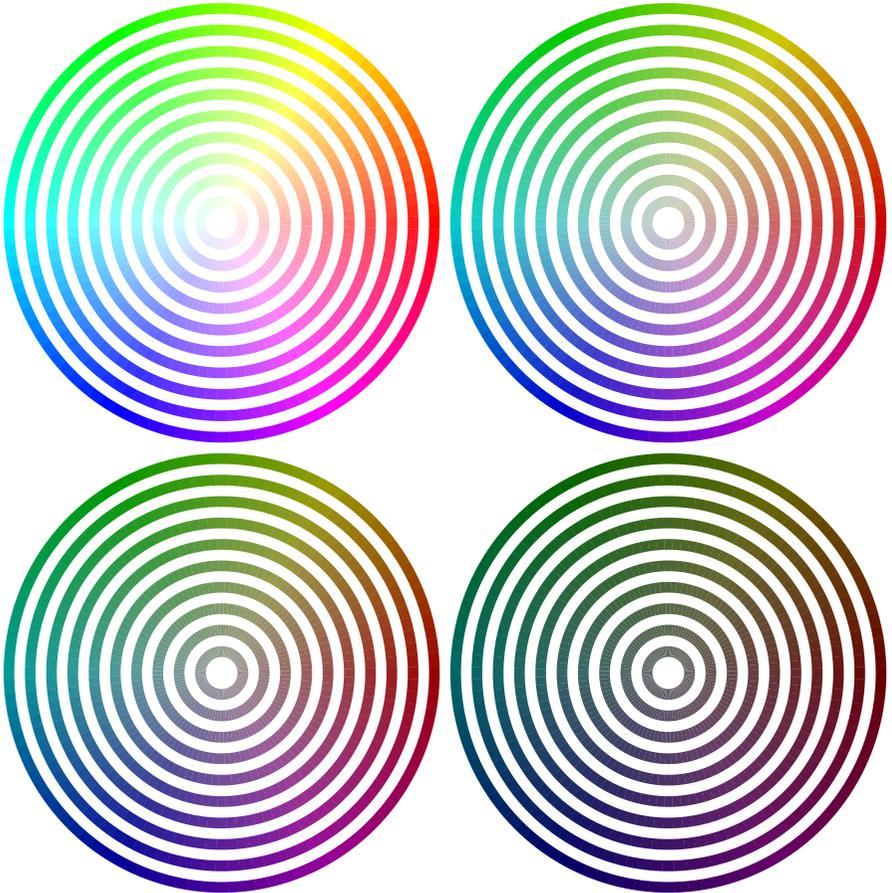
Abbildung 3: Farben im **hsb**-System ( $h = 0, 0.01, 0.02, \dots, 1$  im Gegenuhrzeigersinn,  $s = 1, 0.9, \dots, 0.1$  von außen nach innen,  $b = 1, 0.8, 0.6, 0.4$  von links oben nach rechts unten)
