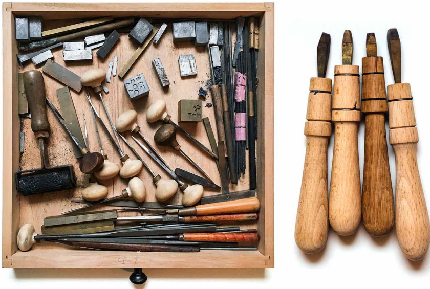
Abb. 2: Links: Das Werkzeug mit dem Gudrun Zapf-von Hesse 1946 die Messingstempel anfertigte, hat sie bis heute aufgehoben (fotografiert vom Autoren in der Werkstatt von GZvH). Rechts: Mit Holzgriffen versehen, dienten die Buchstaben der Buchbinderin über Jahrzehnte als Werkzeuge zum Vergolden von Schriftzügen auf Bucheinbänden (fotografiert von Norman Posselt).
