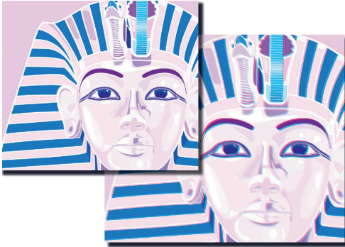
Bild mit richtigem und mit schlechtem Passer (nur Magenta und Cyan-Auszug)
