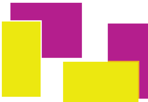
Blitzer und Überfüllung (übertrieben dargestellt)
