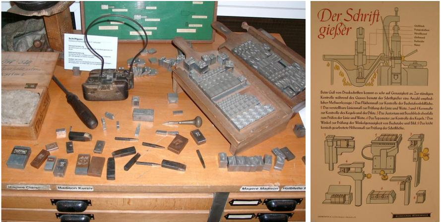
Abbildung 29: Die Utensilien für den Schriftguss: Handgießinstrument zum Probe-gießen, gegossene Buchstaben mit Angusszapfen, justierte Matern, ...
